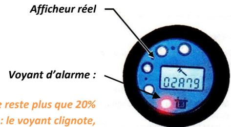
*Lorsqu'il ne reste plus que 20% de batterie : le voyant clignote, la vitesse est réduite de 25% et la fonction « levée » des fourches est désactivée.*
